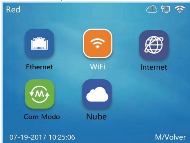
5 Activa WIFI y selecciona DHCP. Elige el WiFi con el que se conecte en ESSID, introduce la contraseña y prueba la conexión.
